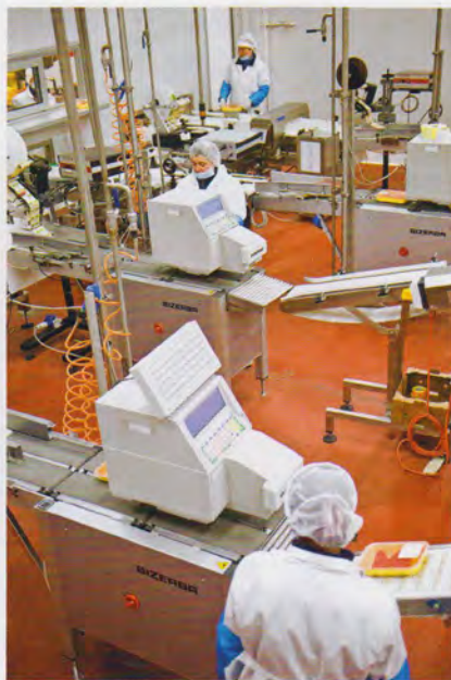
Linea per il confezionamento delle vaschette in ATP.
